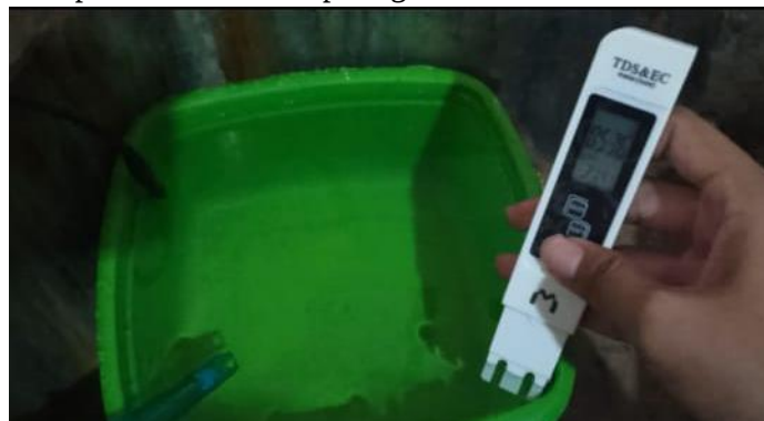
Gambar 9. Pencelupan sensor dan alat manual
