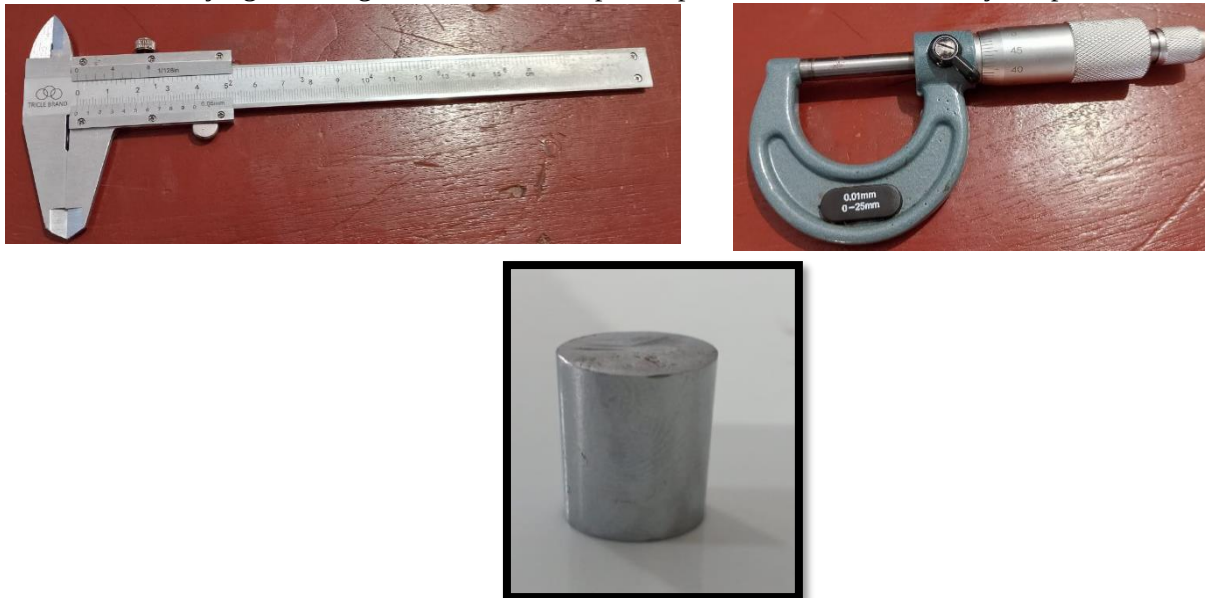
Gambar 1 Alat ukur jangka sorong, mikrometer sekrup dan spesimen besi selinder
