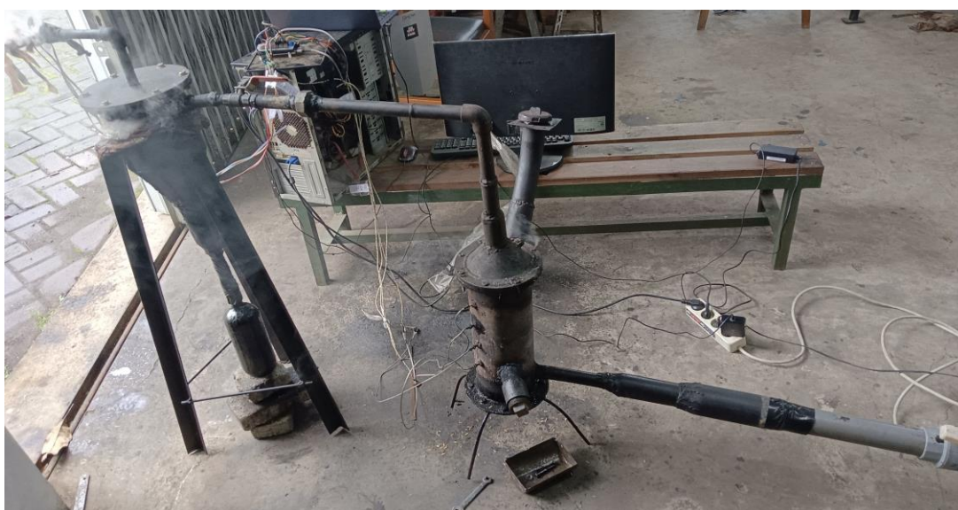
Gambar 1. Setup Penelitian Gasifikasi Updraft
