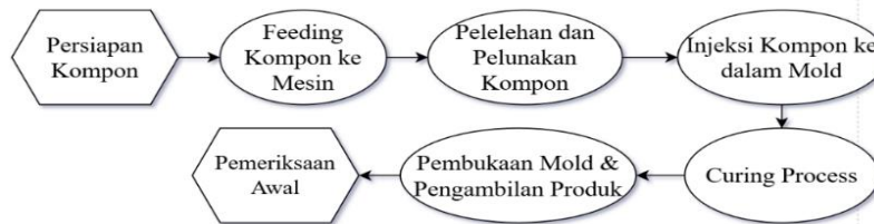
Gambar 5. Diagram alir proses produksi menggunakan mesin pencetak injeksi.
