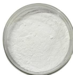
Gambar 2. Serbuk Cangkang Landak Laut setelah Kalsinasi 1.000\text{ }^\circ\text{C} ( \text{CaO} )
