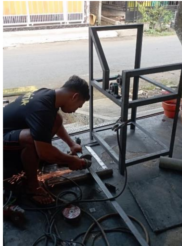
Gambar 3 Proses Pemotongan Besi Siku
