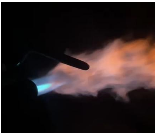
Gambar 9. Nyala api terbaik secara visual pada laju aliran udara 3,5 m/s dan rasio 600 DA–400 RA.
