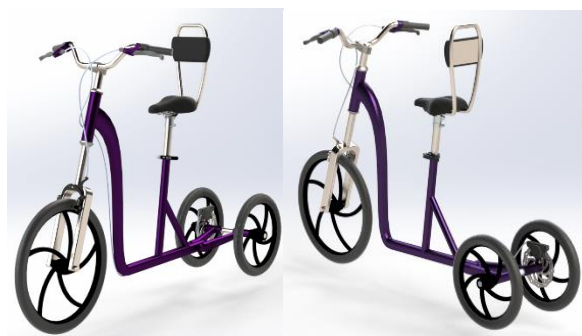
Gambar 8 rancangan rangka sepeda roda tiga tanpa pedal
