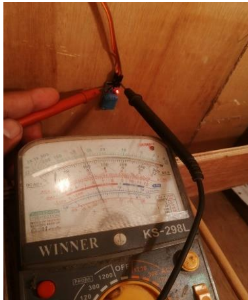
Gambar 12. Uji Sensor DHT
