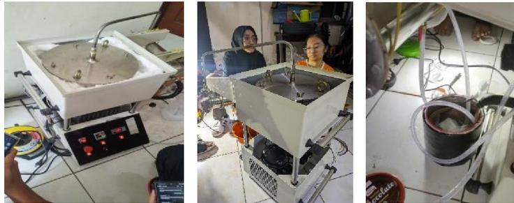
Gambar 2. Alat pirolisis dengan pendingin *Chiller*
