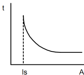
Gambar 5. Karakteristik Rele Arus Lebih IDMT
