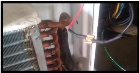
Gambar 14. Pengujian Sistem Pengkabelan dengan Mengkorsletkan Kabel *Thermistor*
