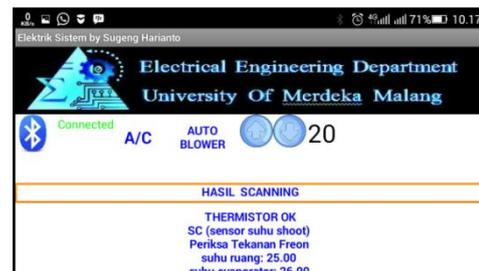
Gambar 17. Tampilan pada *Smartphone Android* dengan Cara Mengkorsletkan Kabel
