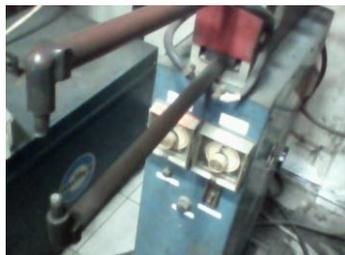
Gambar 4. Mesin las titik
