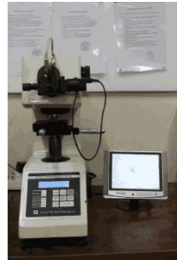
Gambar 5. Mesin uji kekerasan micro vickers
