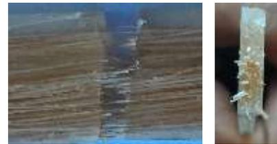
Gambar 4.14 Hasil foto makro pengujian tarik fraksi volume serat 40%
