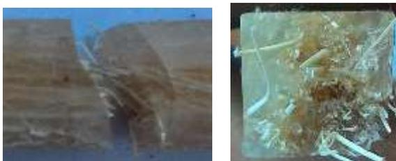
Gambar 4.10 Hasil foto makro pengujian impak fraksi volume serat 50%
