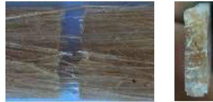
Gambar 4.13 Hasil foto makro pengujian tarik fraksi volume serat 30%
