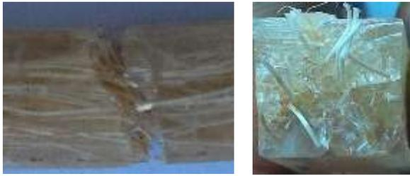
Gambar 4.8 Hasil foto makro pengujian impak fraksi volume serat 30%
