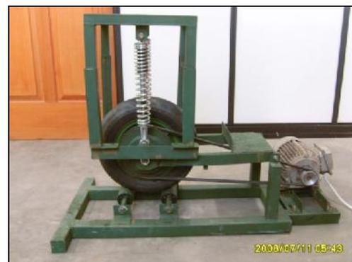
Gambar 3. Alat penguji keausan
