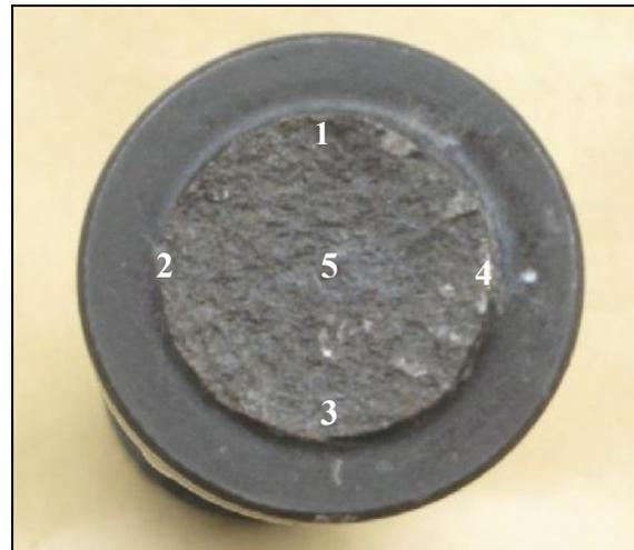
Gambar 6. Lokasi pengukuran kekerasan camshaft pada daerah patahan (diameter luar poros)
