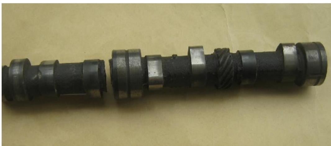
Gambar 1. Camshaft yang patah
