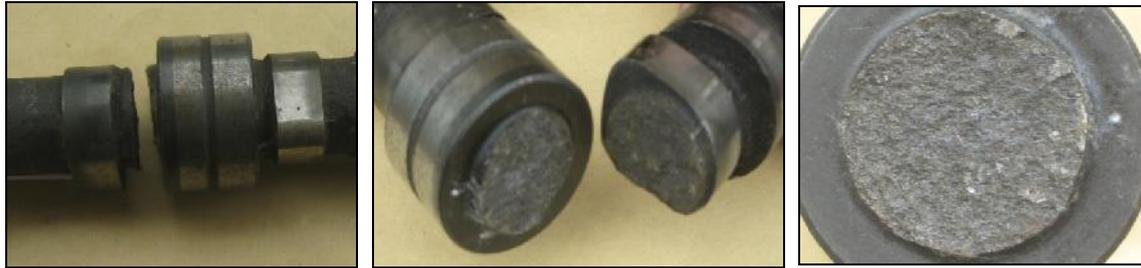
Gambar 2. Bentuk patahan camshaft
