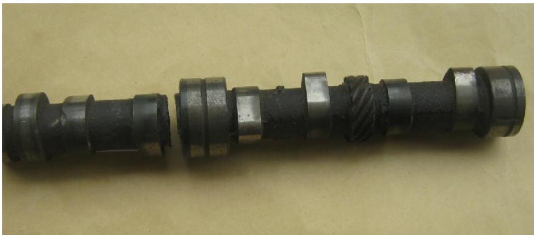
Gambar 1. Camshaft yang patah
