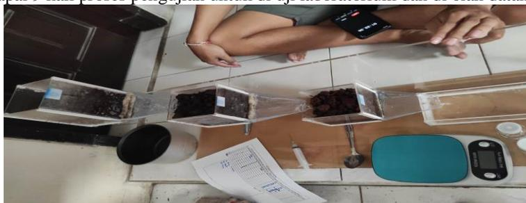
*Dok.Pribadi Gambar proses pengujian penuangan air laut pada filter*
