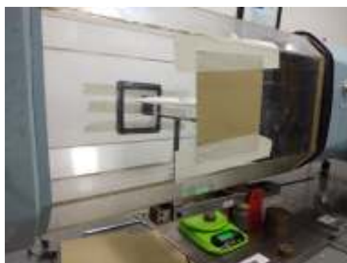
Fig. 5. Keadaan airfoil setelah terpasang
