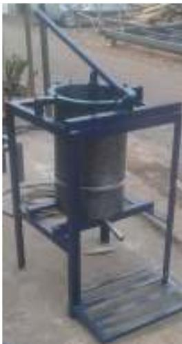
Gambar 1. Mesin Pengepresan Bubur Kedelai
