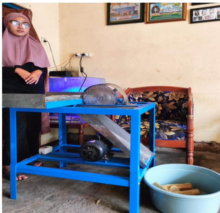
Gambar 2. Mesin Alat pemotong krupuk yang siap dioperasikan
