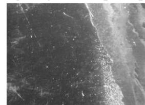
Gambar 18 Cacat Material Lapisan Terkelupas
