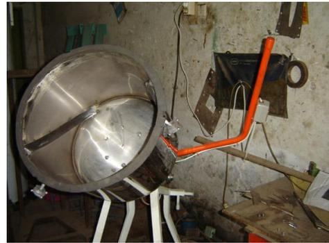
Gambar 6. 1 – 4 Pembuatan Alat Pencampur Bumbu Keripik Tempe
