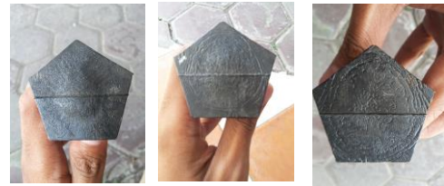
Gambar 7. Cacat warping pada produk tekanan 80 Bar
