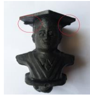
Gambar 8. Cacat flashing pada produk
