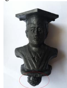
Gambar 10. Cacat buble pada produk
