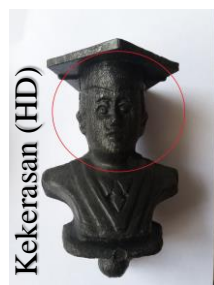
Gambar 9. Cacat burn mark pada produk
