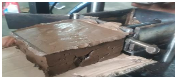
Gambar 3. Hasil Mesin Press Hidrolik Batu Bata
