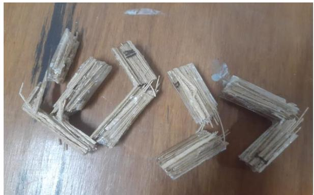
Gambar 3 Spesimen hasil uji *impact* dengan perlakuan alkali serat salak variasi perendaman 1 jam sampai dengan 4 jam.
