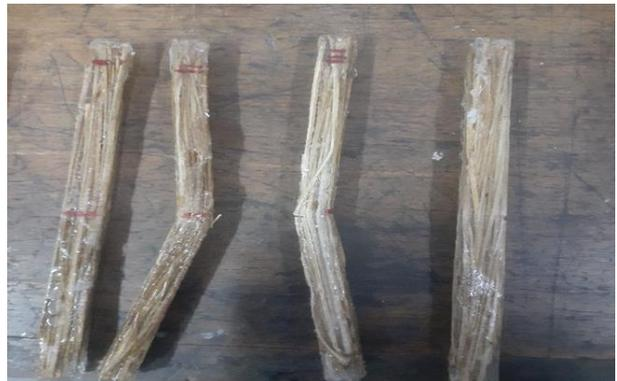
Gambar 5 Spesimen uji *bending* dengan perlakuan alkali serat salak dengan variasi perendaman 1 jam sampai dengan 4 jam
