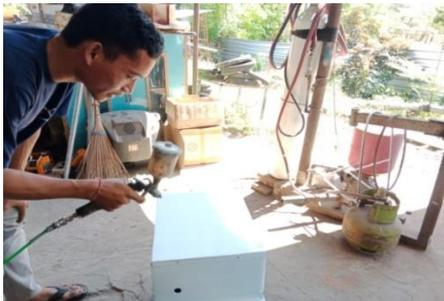
Gambar 6 Pengecatan *casing box panel* sistem kontrol.
