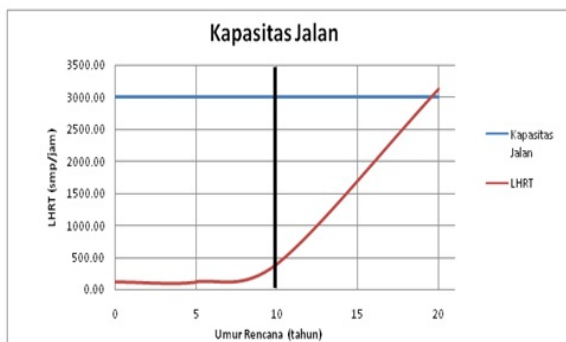
Gambar 3. Hubungan Kapasitas Jalan Dengan Umur Rencana
