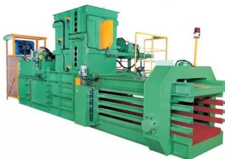
Gambar 1. Mesin Baling Horizontal Sumber : Peneliti
