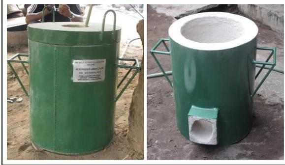
Gambar 24. Alat Pelebur Limbah Logam
