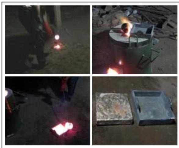
Gambar 29. Proses pengambilan kotoran, pemanasan cetakan, penuangan cairan kuningan dan hasil cetakan
