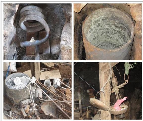
Gambar 11. Kompor, kowi, peralatan peleburan dan timbangan
