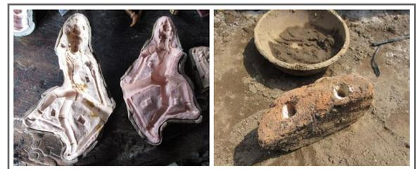
Gambar 14. Cetakan negatif dari silikon dan tanah
