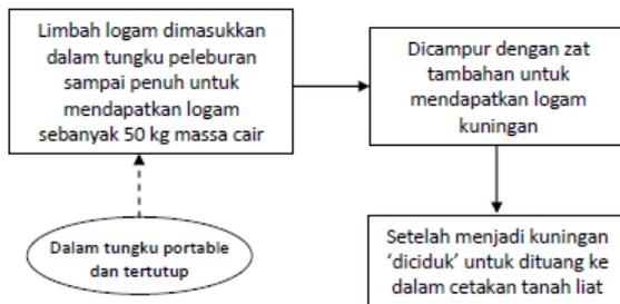
Gambar 5. Operasional Alat Pelebur yang Diusulkan
