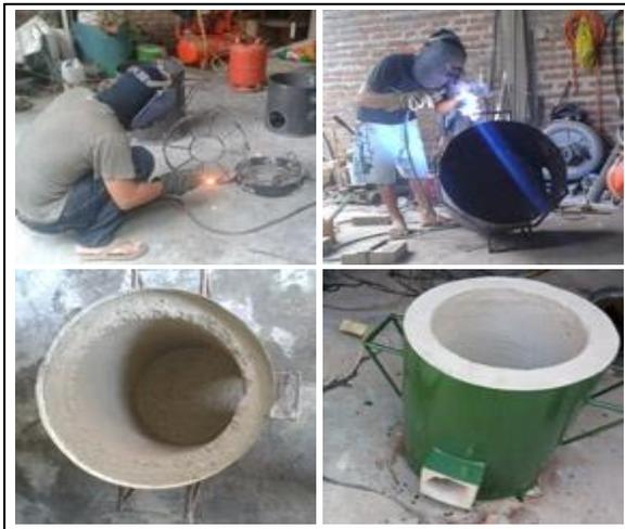
Gambar 19. Proses Pembuatan Tungku
