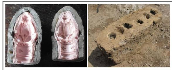
Gambar 8. Cetakan silikon dan cetakan tanah
