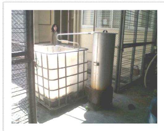
Gambar.1. Alat Destilasi Minyak Atsiri
