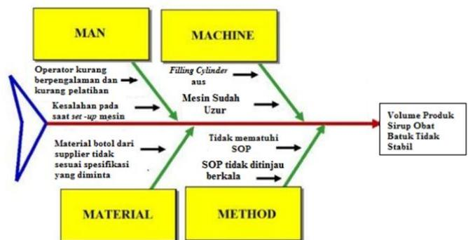
Gambar 3. Diagram *Fishbone* ketidakstabilan volume dalam produksi sirup obat batuk
