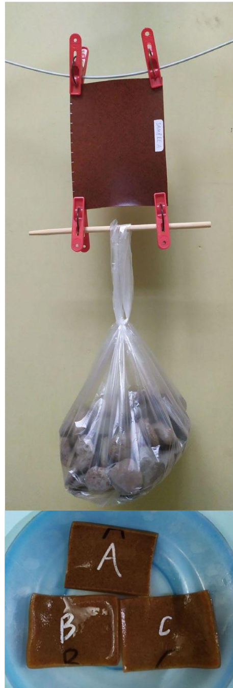
Gambar 9. Pengujian Material: Uji tarik (kiri) Uji Penyerapan Air (Kanan)
