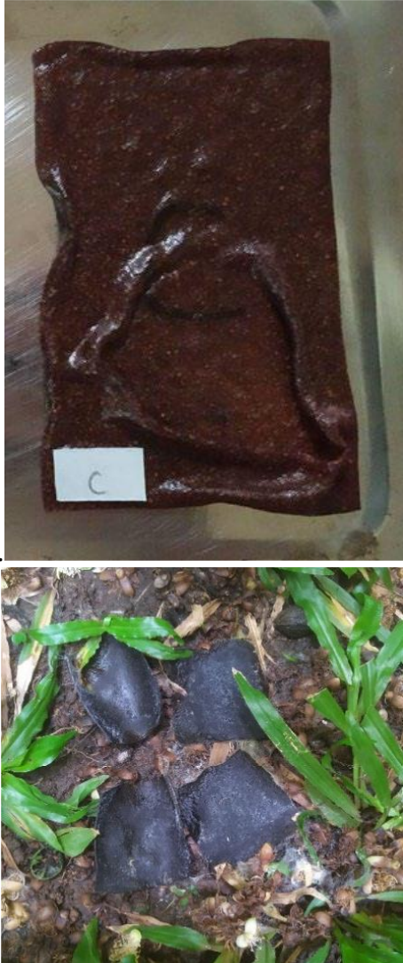
Gambar 10. Pengujian Material: Uji Panas (kiri) Degradasi Bahan Pada Tanah (Kanan)
