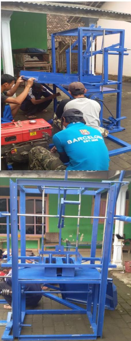
Gambar 1. Mesin Pencetak Batako
