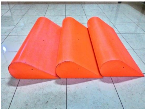
Gambar 8. Bentuk blade kincir angin jenis Lenz2 dilihat dari atas
