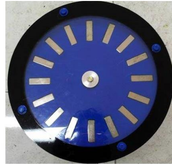
Gambar 13. Rotor 16 kutub dengan permanen magnet
