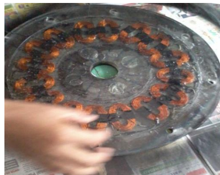
Gambar 14. Stator dengan 16 kutub kumparan
