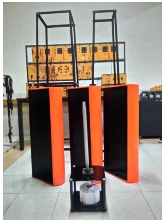
Gambar 10. Bentuk blade kincir angin, tower dan rumah generator
