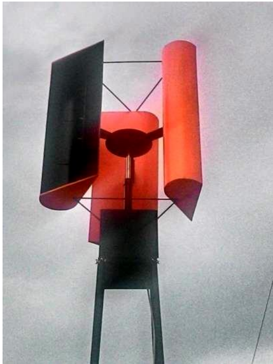
Gambar 11. Model kincir angin sumbu vertikal jenis Lenz2 setelah dirakit
