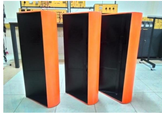
Gambar 9. Bentuk blade kincir angin jenis Lenz2 dilihat dari samping
