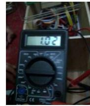
Gambar 14. Hasil Pengukuran Arus pada saat motor ON
