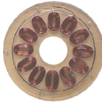
Gambar 12. Konstruksi stator generator dengan 12 lilitan kumparan
