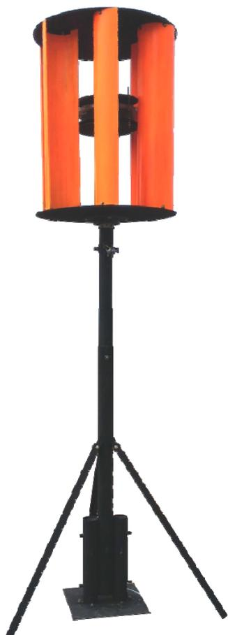
Gambar 15. Konstruksi hasil perakitan kincir angin dan generator magnet permanen dengan tiang penyangga
