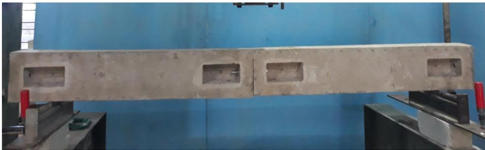
Gambar 13. Dua Beton Pracetak yang di sambung
