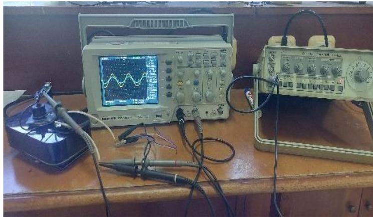
**Gambar 7.** Pengujian menggunakan function generator dan osiloskop
