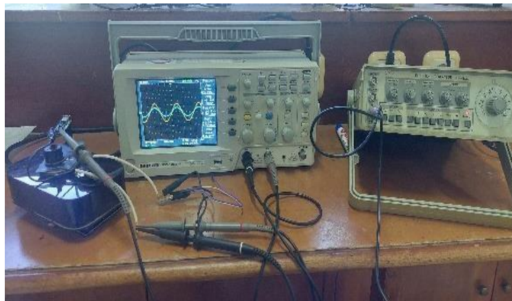
Gambar 7. Pengujian menggunakan function generator dan osiloskop
