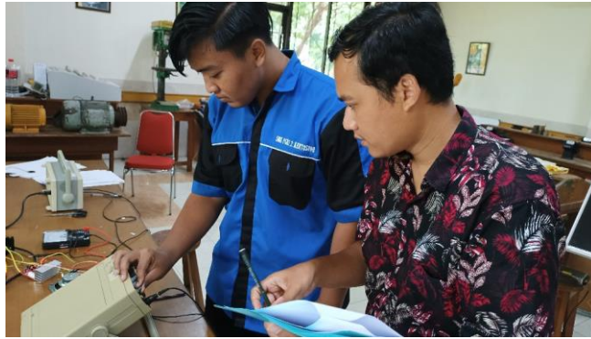
Gambar 11. Pengujian transfer daya secara wireless menggunakan function generator
