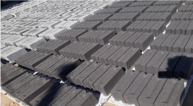
gambar 4 hasil batako menggunakan mesin.
