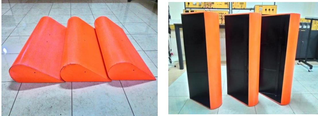
Gambar 2. Hasil pembuatan blade kincir angin jenis Lenz2
