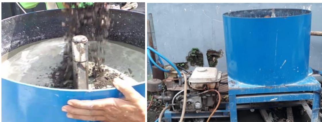
Gambar 4. Proses Peradukan Semen, Pasir, Koral Dan Air
