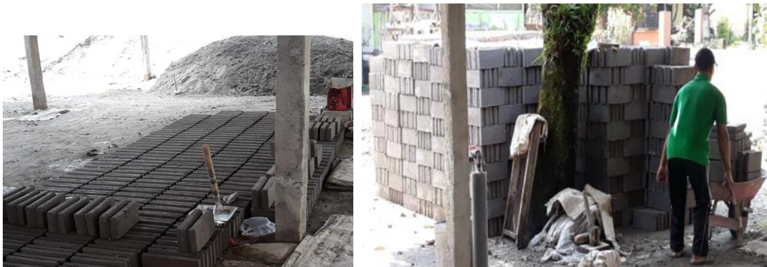
Gambar 5. Hasil batako menggunakan mixer peraduk batako
