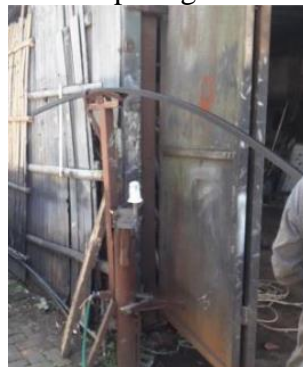
Gambar 2. Proses bending dengan metode manual
