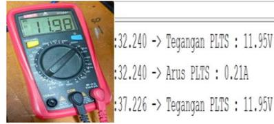
**Gambar 1.** Sensor Tegangan dan Multimeter
