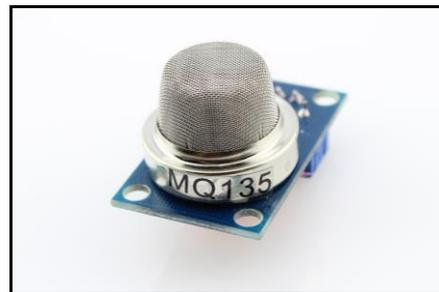
Gambar 2.2 Bentuk Fisik Sensor MQ-135
