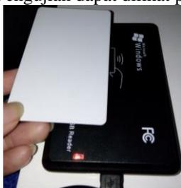
Gambar 4.5 Proses Deteksi Kartu RFID
