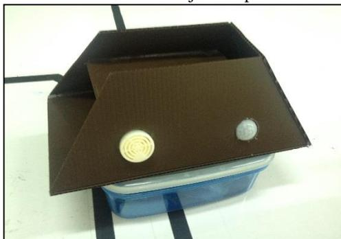
Gambar 8. Hasil implementasi *hardware* berupa gabungan sensor PIR dan buzzer
