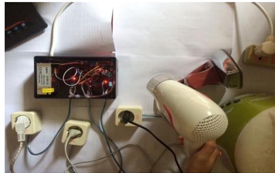
Gambar 8 Pengujian Sensor Arus ACS712
