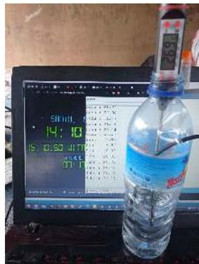
Gambar 16 pengujian sensor DS18B20
